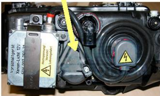
Zapaľovač elektrického oblúku výbojky (ignitor)
